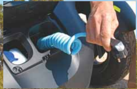
Im Servicefach vorne finden sich der Wischwasserbehälter und ein drei Meter langes Ladekabel.
