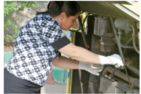
Kontrollgang: Zur Buspflege gehört auch das ständige Prüfen des Ölstands.
